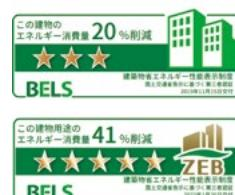
\*ZEB:Net Zero Energy Building。先進的な建築設計や自然エネルギー活用、高効率な設備導入などによりエネルギー負荷を抑制し、建物で消費する年間一次エネルギーの収支ゼロ実現を目指した建築物
